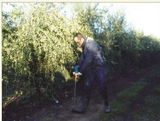
Fotografía 1: Cámaras portátiles tipo "pump-up" utilizadas para medir potencial hídrico de tallo en olivar
