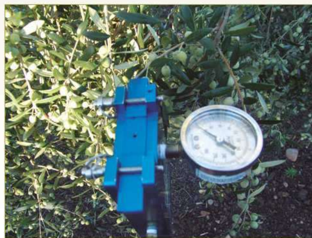
Fotografía 1: Cámaras portátiles tipo "pump-up" utilizadas para medir potencial hídrico de tallo en olivar
